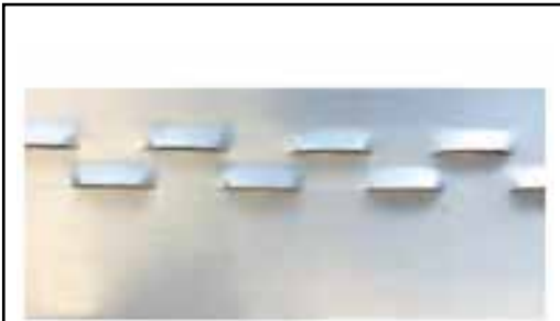
Les rouleaux pour fentes oblongues standard MASC permettent des estampages réguliers et de profondeur identique sans avoir à mesurer et dessiner au préalable, ce qui représente un gain de temps considérable.
